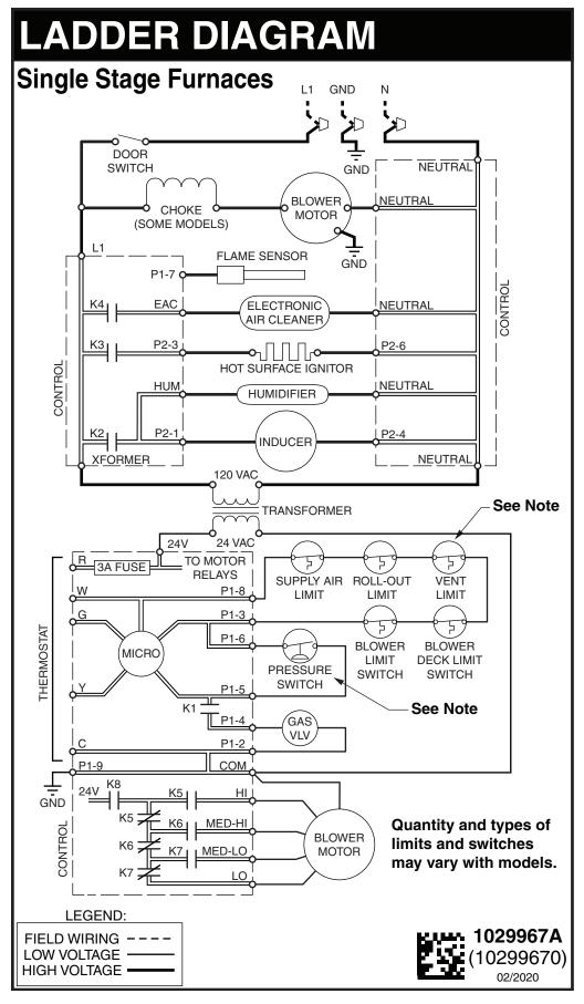
Figure 23. Nordyne/UTEC Ladder Diagram
