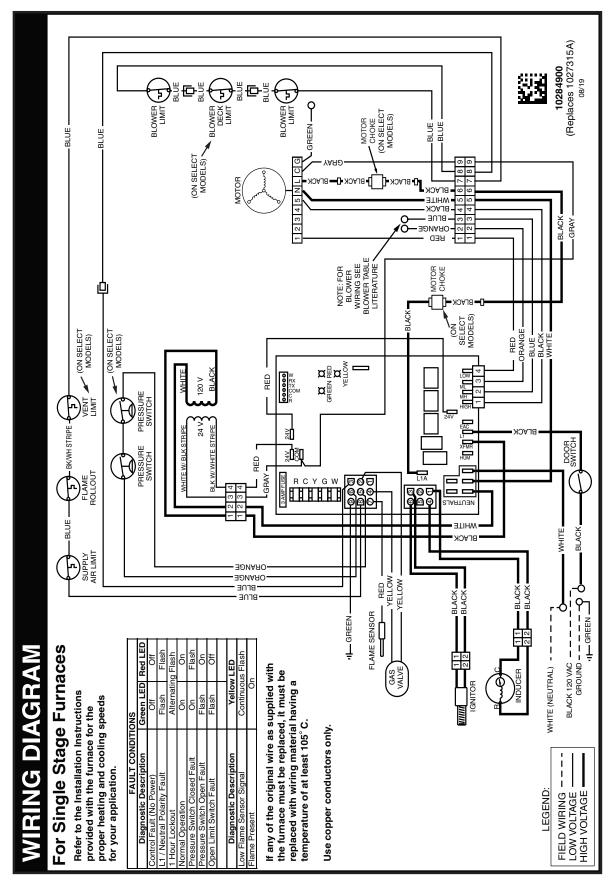
Figure 21. Nordyne/UTEC Wiring Diagram
